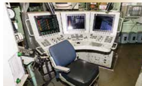
Figure 3. Console du système intégré de commande des machines conçue pour les frégates de la classe Halifax .
