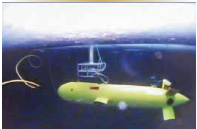
Figure 1. Les AUVs travaillant sous la glace ou à des grandes profondeurs comptent sur un système de navigation inertielle, mais n'ont pas accès aux informations d'un système GPS afin de corriger les petites erreurs de dérive du système INS.
