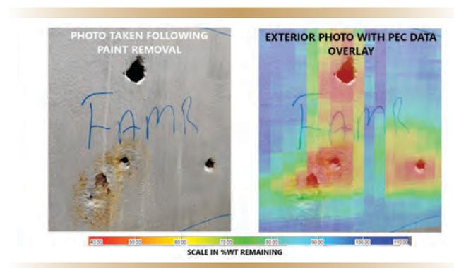
Figure 5. Exemples de défektivités connues et résultats de balayage correspondants d'une inspection de la coque en 2022.
