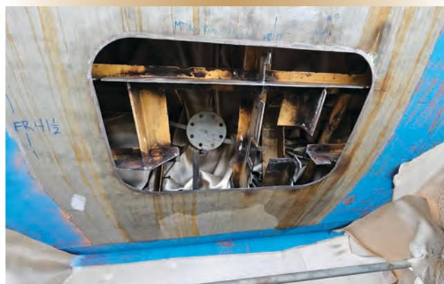
Figure 1. La technologie de balayage aux CFP donne un aperçu de l'état de la corrosion dans les zones difficiles d'accès de la structure du navire, ce qui permet au personnel d'entretien de savoir quelles sections doivent être ouvertes aux fins de réparation.
